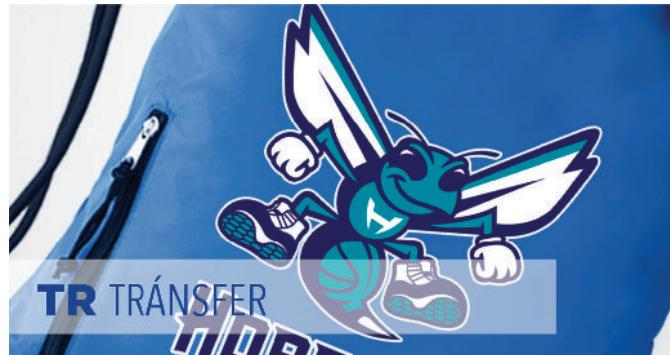
El transfer es un papel que posee adhesivo, se imprime en inyección de tinta o láser a selección de color para después ser transferido en forma de planchado sobre el material.
